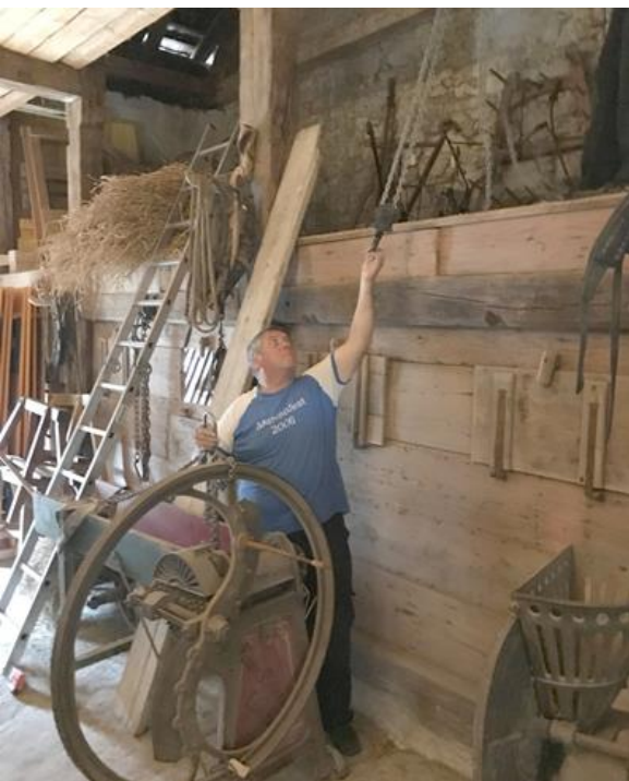
Die Kurzfuttermaschine wird von Hans Bürgin mit dem Flaschenzug auf die Heubühne gehoben
