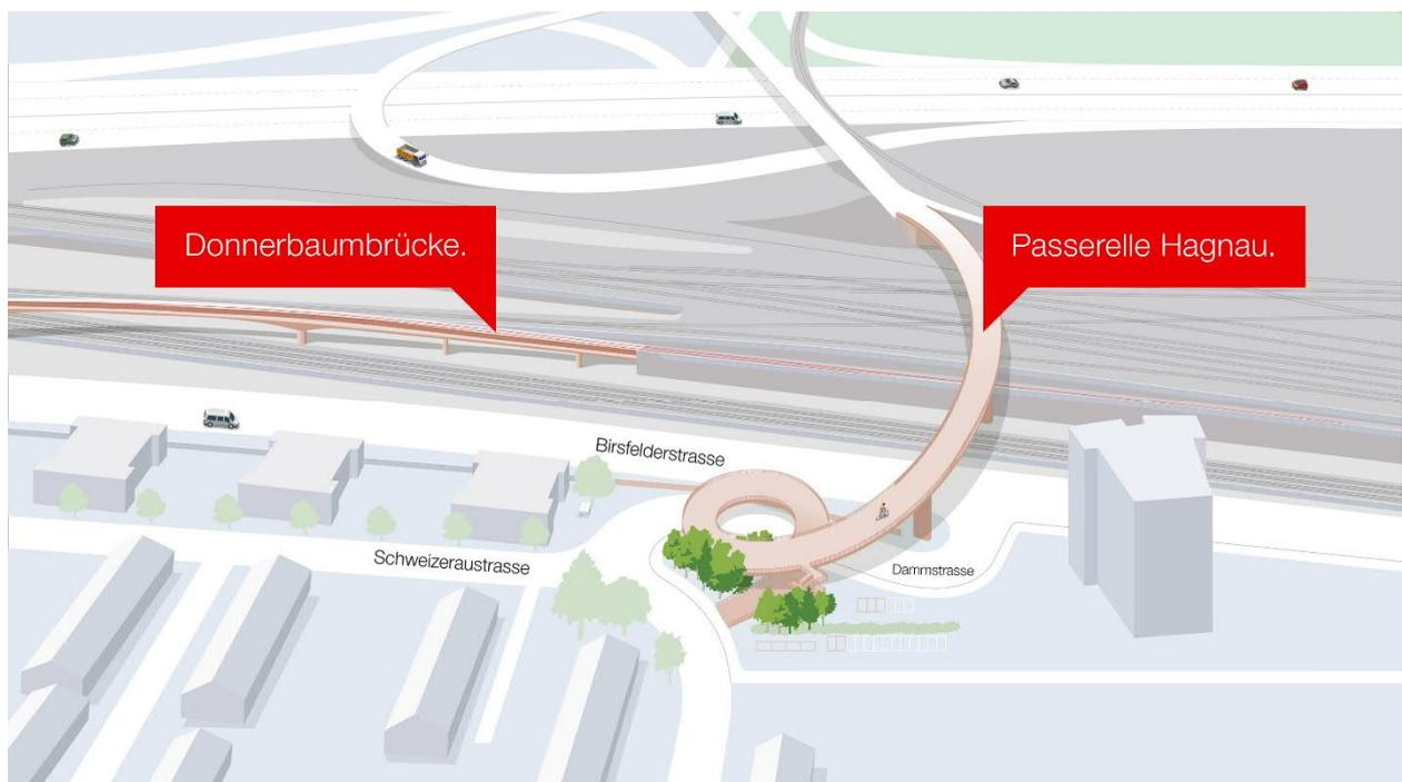
Die neue Passerelle Hagnau – der Neubau ist nötig, weil die heutige Passerelle in das sogenannte Lichtraumprofil des Gleises ragen würde, welches über die Donnerbaumbrücke führt.
