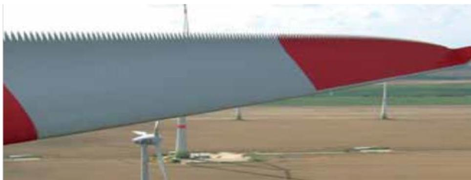
Abb. 3 Trailing Edge Serrations an einem Enercon-Rotorblatt (Quelle: Enercon).
