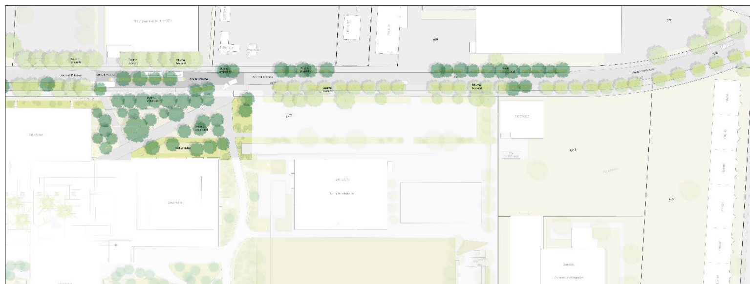
Abb. 2 Sanierung/Neugestaltung Kriegackerstrasse Ost, Ausschnitt aus Gestaltungsplan, v.l.n.r.: Sek-II-Platz mit Bushaltestelle Kriegacker, Fortführung des Grünzugs in südlicher Richtung neben umgebautem Hauptgebäude Sek-II-Schule, Fortführung des Grünzugs in östlicher Richtung entlang der Kriegackerstrasse bis zum FHNW-Park
