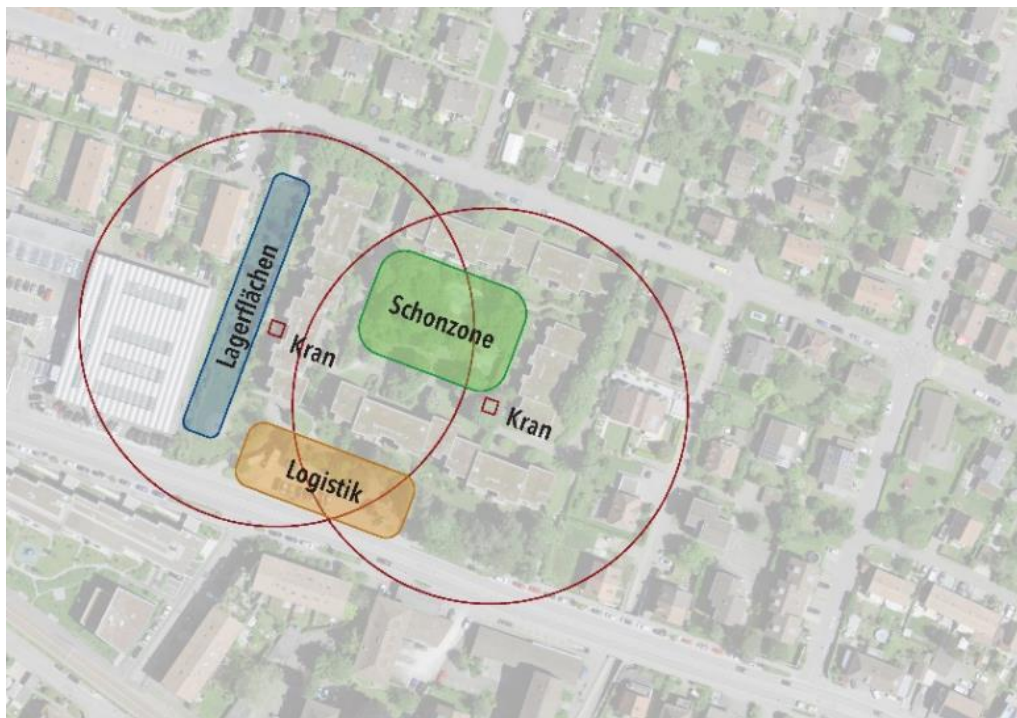
Abbildung 8 Schema Baustellenlogistik, Stand 21.05.2024 (Quelle: Nord GmbH Architekten)
